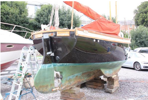
Mayfly Corsaire long keel with bilge fins
